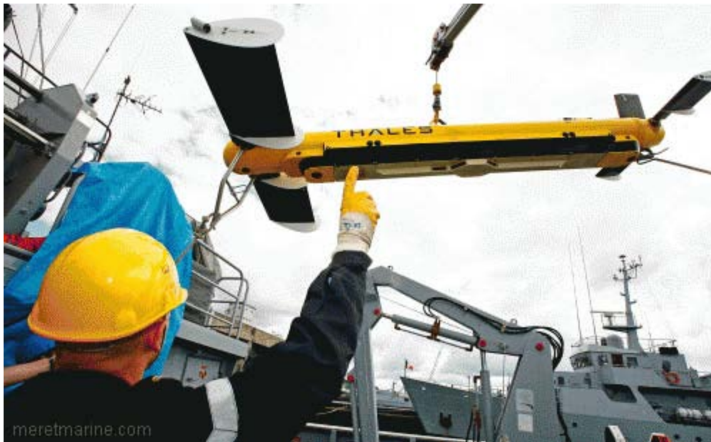
Le sonar à antenne synthétique DUMB-44 (© : THALES)
