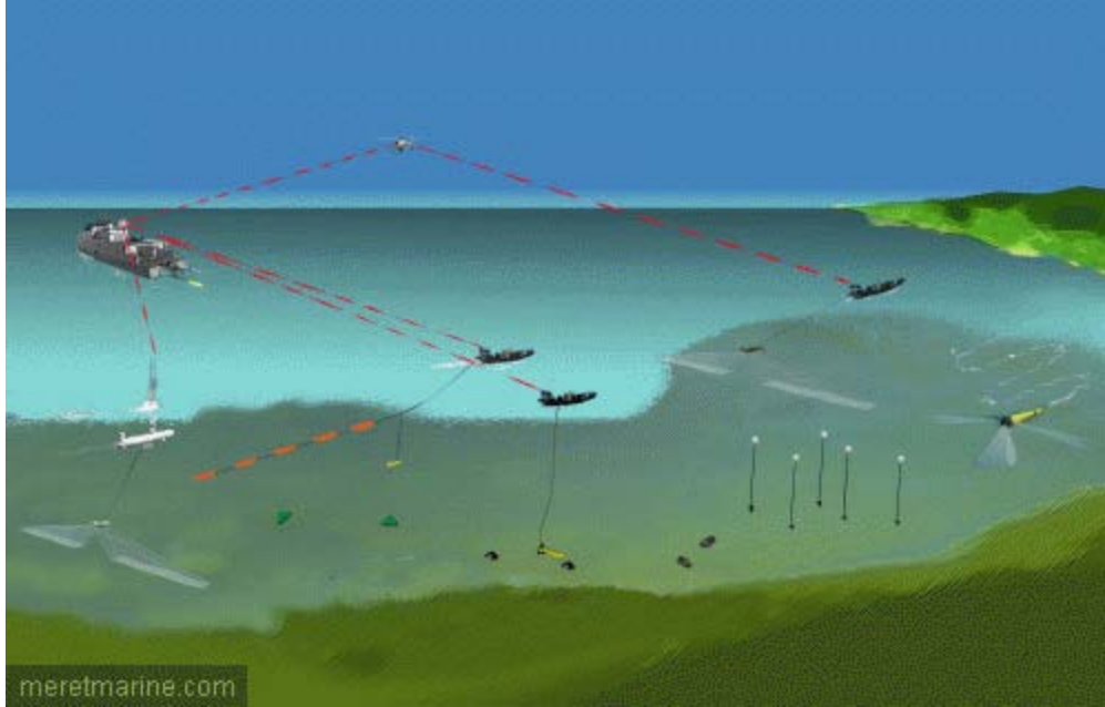
Le principe du SLAMF (© : DCNS)
